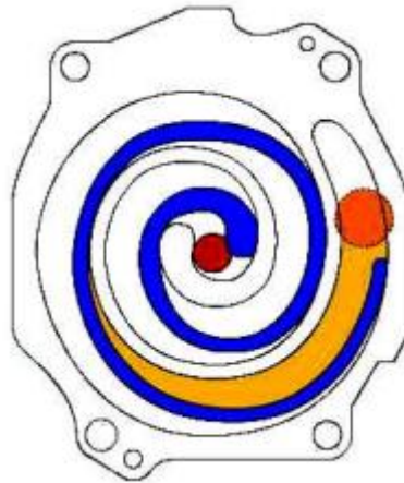
Hình 1.24 : Nguyên lý hoạt động của máy nén kiểu xoắn ốc
