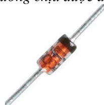
Diode xung loại nhỏ cho tần số cao qua được nhưng chịu được dòng thấp
