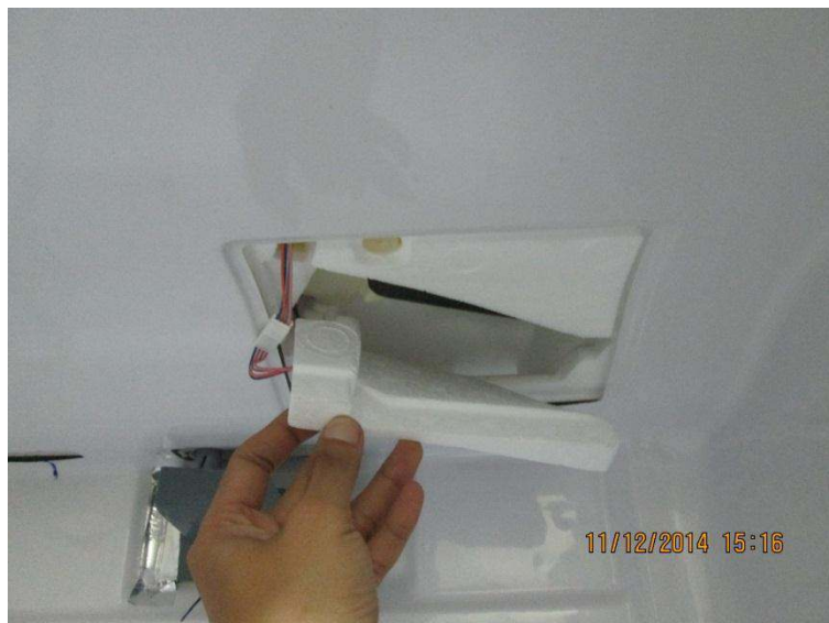
Tháo xốp che damper
